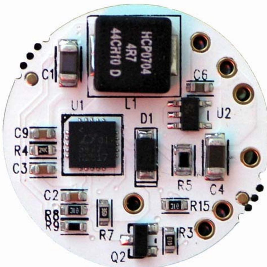
En soudant des câbles sur la platine du maxFlex6, il faut faire attention à ne pas dessouder de composants ni à créer accidentellement de court-circuit près de l'endroit de la soudure.
