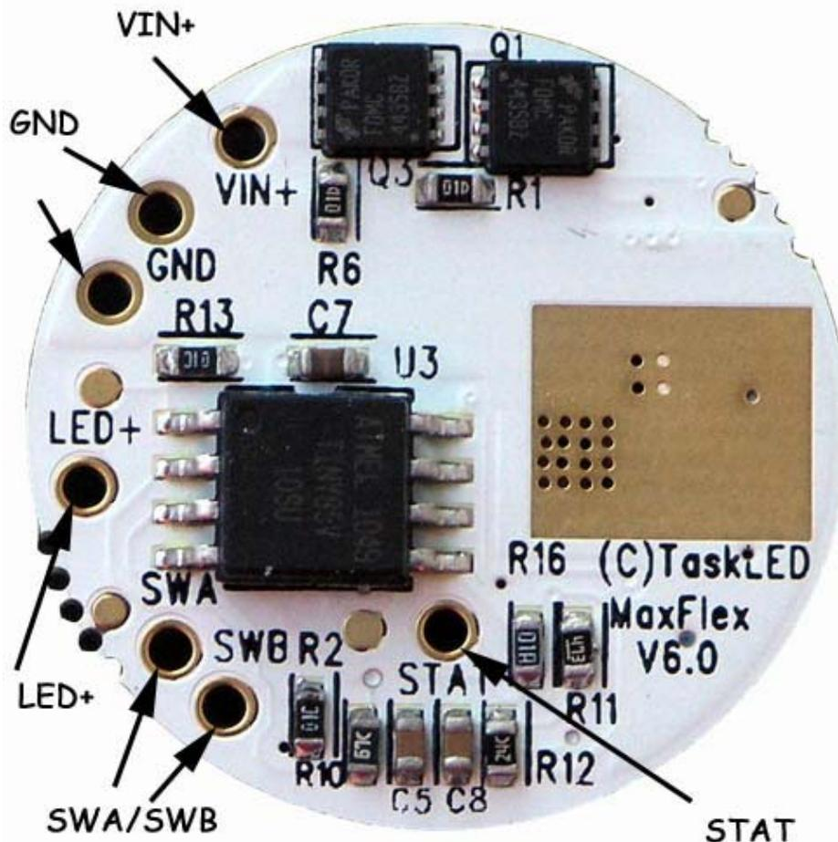
L'illustration précédente montre les connexions du maxFlex6. L'alimentation se fait en courant continu (DC) via une batterie ou une alimentation etc.
