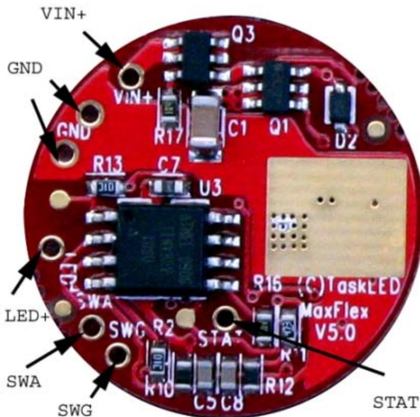
L'illustration précédente montre les connexions du maxFlex. L'alimentation se fait en courant continu (DC) via une batterie ou une alimentation etc.
