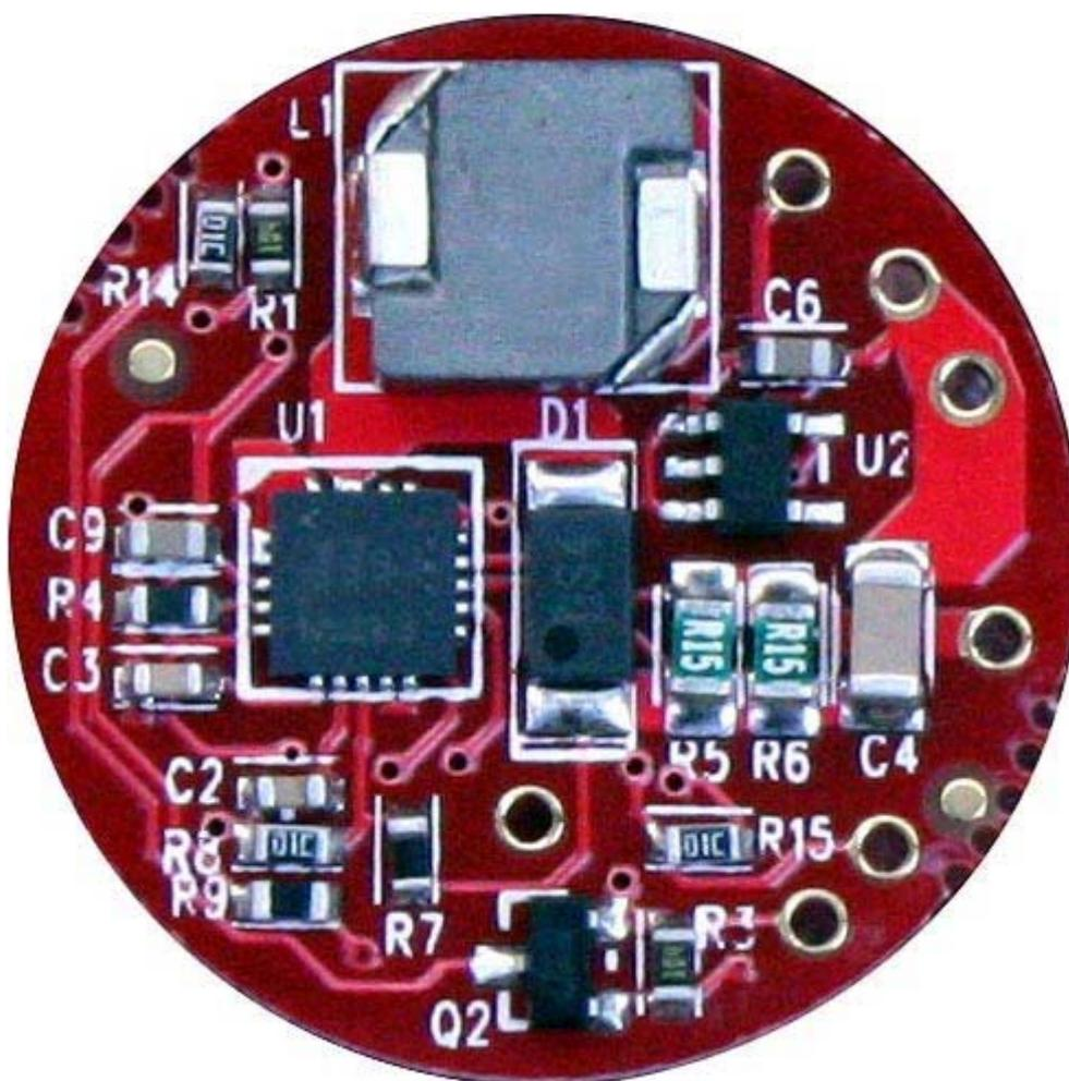
En soudant des câbles sur la platine du maxFlex, il faut faire attention à ne pas dessouder de composants ni à créer accidentellement de court-circuit près de l'endroit de la soudure.
