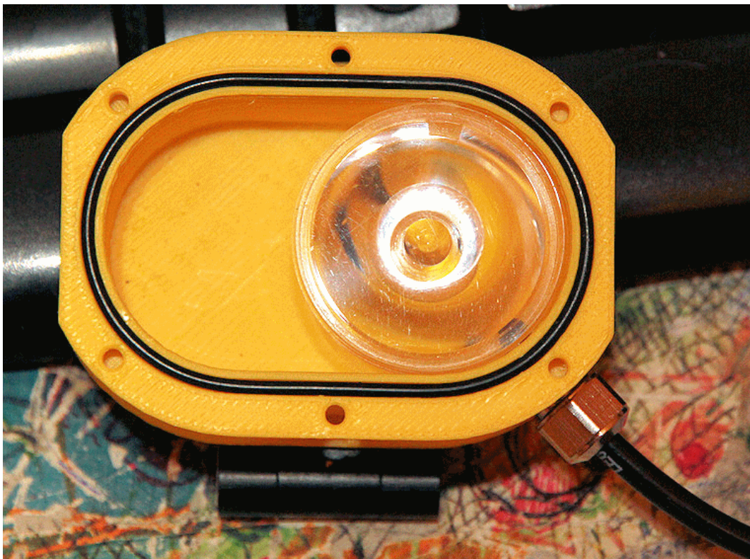
Maquette équipée de ses joint torique, presse-étoupe, câble et lentille spot. Photo Serge C.
