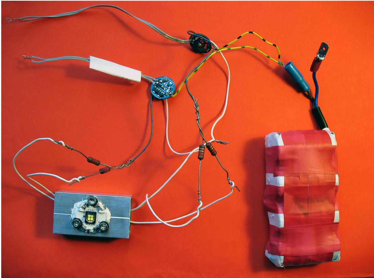
**Circuit test CREE MC-E 430 LUMENS@0.35A/chip \*1 AMC7135 (modifié par une résistance 39 ohms de sortie en parallèle a celle d origine) commande 2 chips , chaque chips possede une résistance de 1.2 ohms en serie , tous les + de la cree sont reliés.
