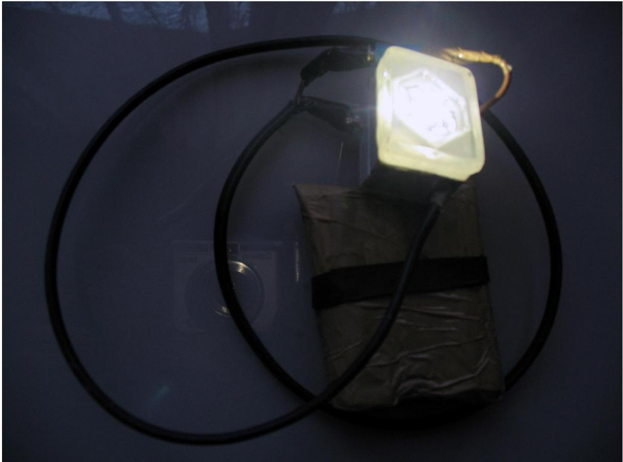
**ACETOLED : avec un pack d'accus 3 elements NIMH 3800 mah (GP380AFH) ...autonomie theorique = 9h (- de 200g) si on utilise un LIPO 5000 / 3.7V ... = 12h ! (pour 100g) adieu acéto :)**
