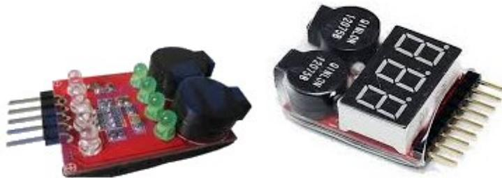
*LiPoBuzz à Leds et LiPoBuzz avec voltmètre incorporé.*
