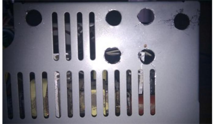
*Perçages des avant-trous puis trous terminés (sur deux modèles différents)*
