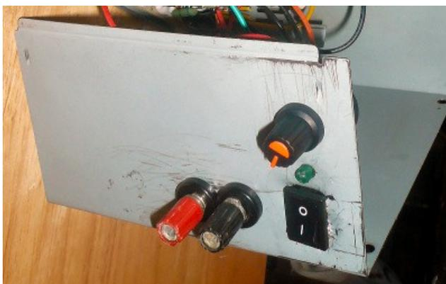
*Modèle d'alimentation PC à sortie variable avec potentiomètre.*
