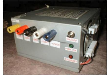
Vue finales de différents modèles d'alims à prises bananes sur le châssis principal.
