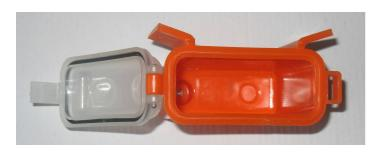
L'étanchéité du couvercle peut être facilement améliorée si nécessaire (voûte mouillante) en ajoutant de la graisse silicone au niveau du Joint torique.
