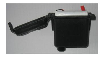
Avec un pack de batteries Lithium. 4 cellules 18650 (7.4V, 5.1 Ah) placées à l'horizontal et une cosse JST.
