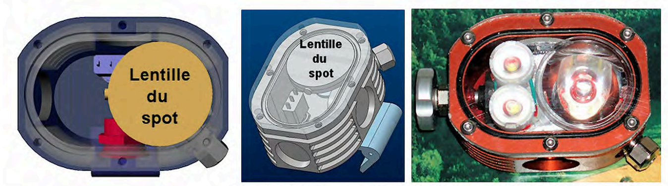
Figures 150 et 151 : Positions de la lentille spot. Figure 152 : Lentille spot en place dans un boîtier LED1777.
