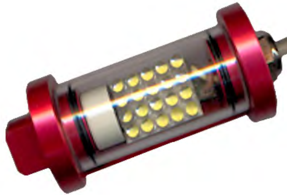
Figure 53 : LedLampe 1 de TechTonique (Suisse). En 1998, il s'agit de la première lampe frontale à LEDs du marché. En tout point innovante, elle exploite déjà les nouvelles possibilités offertes par les LEDs, comme un gradateur de lumière 0-100 %, la gestion électronique de la fin de vie des piles, une surface phosphorescente, etc. Source : TechTonique.
