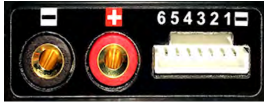
Figure 165 : Les sorties d'un chargeur dédié (6S).
