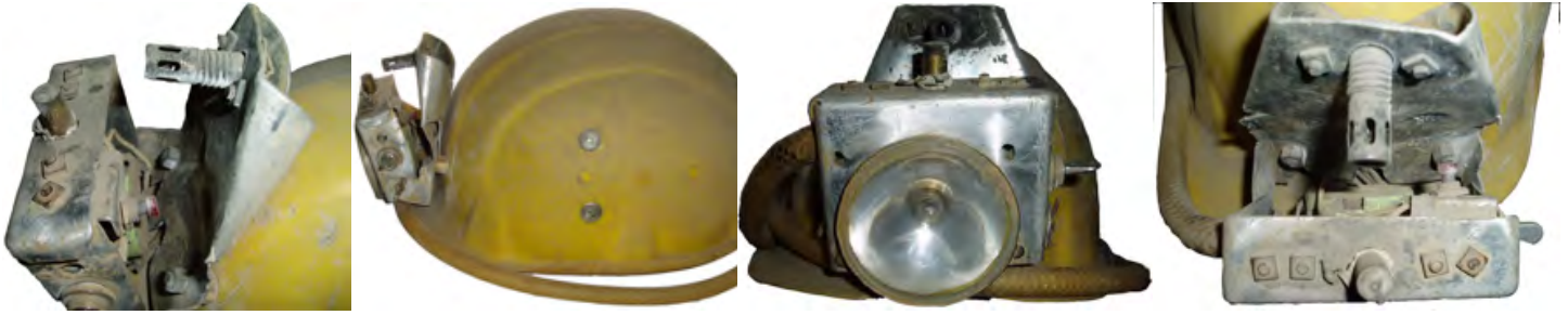
Figures 35, 36, 37, 38 : Éclairage mixte dont les plans ont été publiés en 1972 par l'Association Spéléologique de Côte-d'Or (ASCO) dans son bulletin ASCO n° 2 (1972 1-2) pages 24-28. Notez la focale variable de l'éclairage électrique empruntée à une lampe de poche Wonder. Casque de l'auteur, déposé en 2009 au Musée spéléo de la grotte de la Devèze. Photos JF Balacey.
