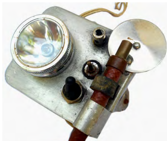
Figure 33 : Lampes fabriquées par Marcel Tourbin, brevetées en 1972 et commercialisées par le « Vieux Campeur ». Extrait du catalogue « Vieux Campeur » de 1981 avec évolution de l'éclairage électrique. Elles se fixent sur le casque via un support dédié ce qui permet d'autres usages du casque. Informations Daniel Teyssier (Spelaion). Figure 34 : Une variante de lampe type Tourbin. Photo Bernard Sebillé.
