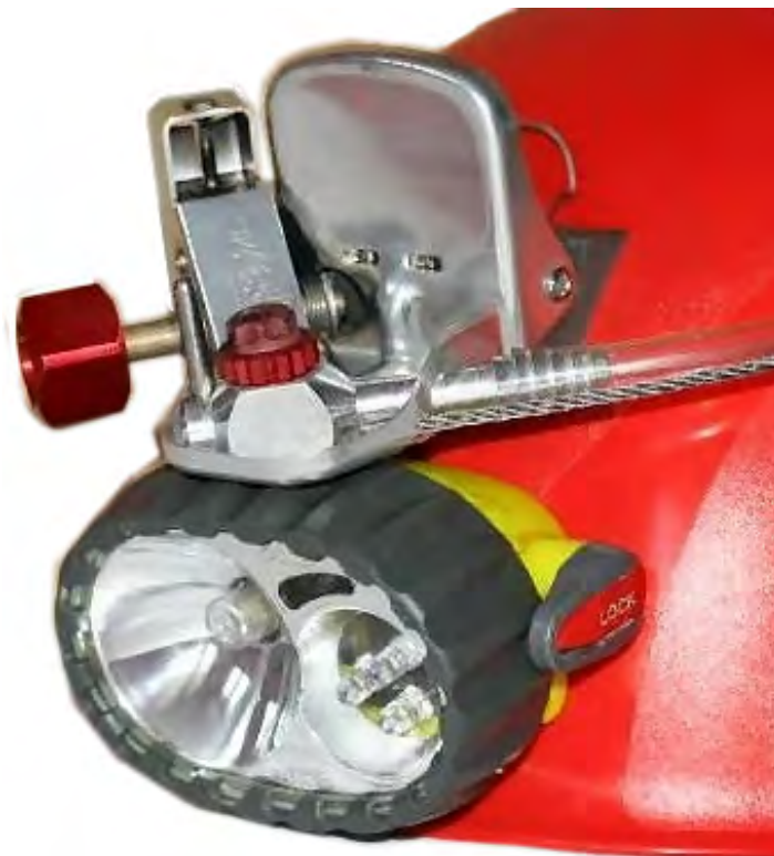
Figures 50 et 51 : Éclairage Duo Explorer commercialisé par Petzl de 1996 à 2012, monté sur casque Petzl Ecrin Roc. On note les deux molettes, une pour l'halogène, avec verrouillage et variation de focale, l'autre pour l'ampoule de secours. Source Petzl.
