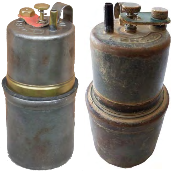
Figures 45 et 46 : Lampes espagnoles Fisma. Petit modèle (capacité en carbure 200 g) à gauche et grand modèle (capacité en carbure 300 g) à droite. Photos Bernard Sebille.
