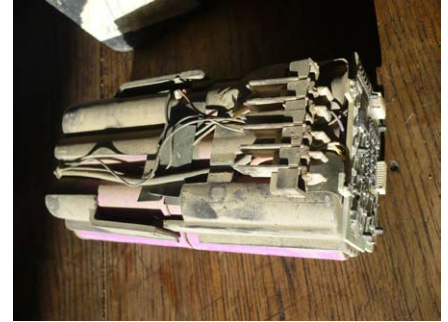
(accu aboutBatteries 2,4Ah : 20 éléments couplés 2 par 2)
