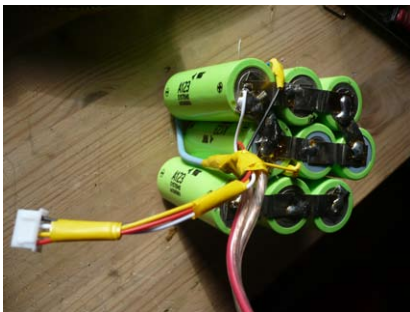
«bloc» d'accu 3S LiFePO4 On a une fiche 4 fils pour la charge, et un gros câble en 2,5mm 2 pour l'utilisation.
