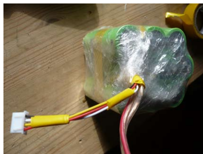
bien emballé dans du cellophane, puis on scotche bien tout ça pour éviter l'humidité. On prend soin de bien noter la technologie, le voltage, le nombre d'éléments en série (3S, 4S, 10S), l'ampérage disponible... et le propriétaire !
