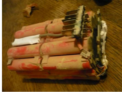
(accu Hilti 3,9Ah : 30 éléments couplés 3 par 3)
