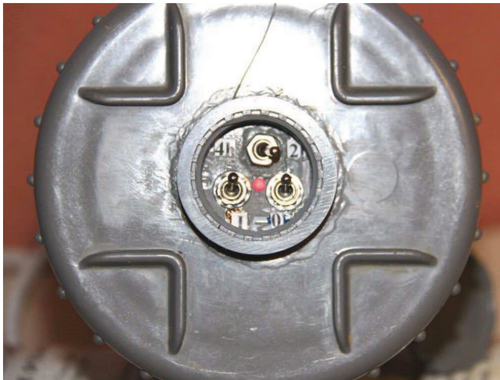
Photo 4 : Boutons de commande et LED témoin vus de l'extérieur
