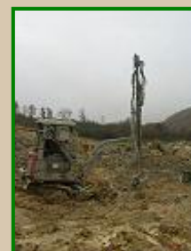
Mini pelle avec LC50 entraînement hydraulique
