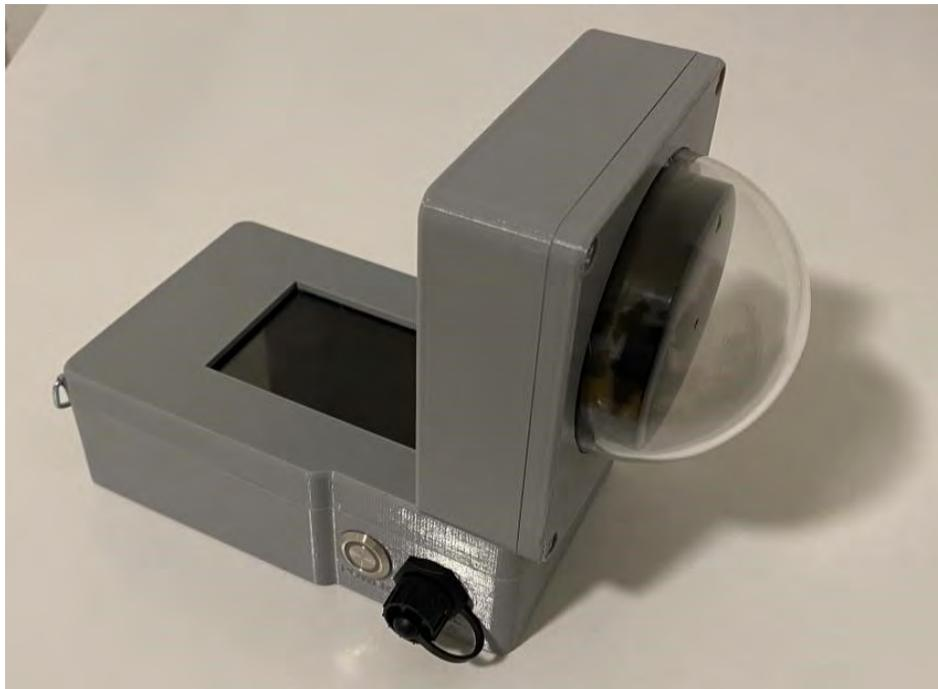
*Caveatron Rev C entièrement assemblé avec le couvercle LIDAR en forme de dôme.*
