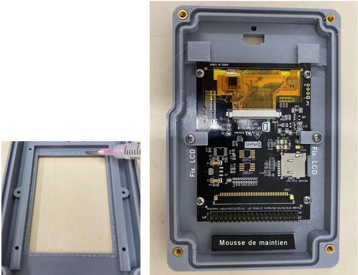
*Ajoutez un cordon de mastic silicone ou époxy autour de l'intérieur de la découpe de l'écran dans le couvercle du boîtier principal (à gauche). L'écran est installé par l'arrière (à droite) avec les vis et les fixations. Assurez-vous de ne pas mettre trop de mastic pour qu'il ne suinte pas sur l'écran et nettoyez l'excédent si nécessaire.*
