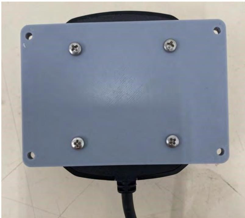
*La face avant du support, où est placé le module LIDAR, est équipée de petits supports de fixation.*
