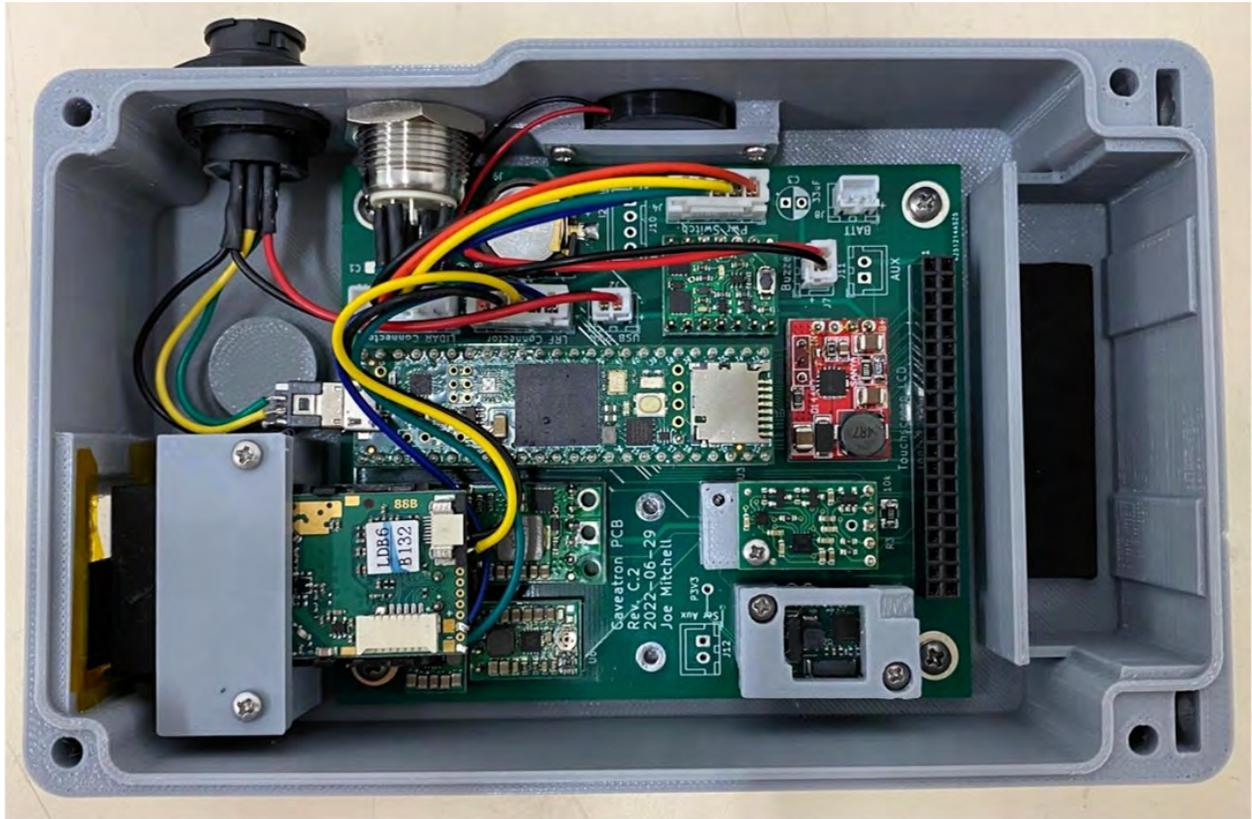
*Base du boîtier principal avec tout ce qui est maintenant installé, sauf la batterie qui va dans le logement du côté droit sur cette photo et qui est montrée installée sur la photo de la page suivante.*
