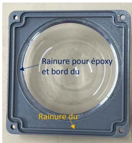
*À l'intérieur du couvercle du dôme pour boîtier LIDAR S2. Le joint torique n'a pas encore été installé.*
