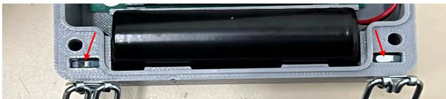
Installez les anneaux en D de la dragonne avec les emplacements des écrous indiqués par les flèches.
