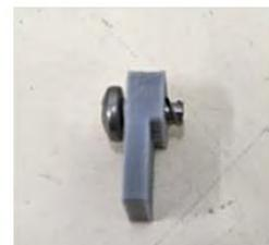
*Orientation des vis des fixations de l'écran LCD*
