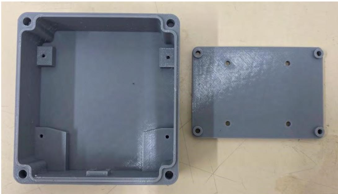
*Base de boîtier RPLIDAR S2 et pièces imprimées en 3D.*
