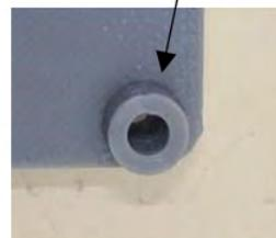
*Support pour le RPLIDAR S2. Assurez-vous que le verso est la face lisse et plate avec le texte imprimé et non la face avec les petites entretoises. La version montrée sur la photo ne possède pas les indicateurs UP/CABLE, qui ont été ajoutés plus tard, mais la distance entre les vis de montage et le bord du support est légèrement inférieure sur le côté où doit se diriger le câble.*
