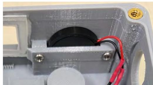
*En haut* : emplacement du buzzer piézoélectrique dans le Rev C Caveatron. *En bas* : processus d'installation (pour un modèle différent). Insérez le buzzer piézoélectrique dans la fente (vue gauche) puis installez le support de fixation (vue droite).
