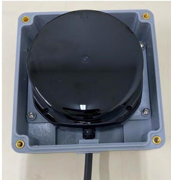
*Base du boîtier LIDAR avec inserts filetés et module LIDAR S2 installé.*
