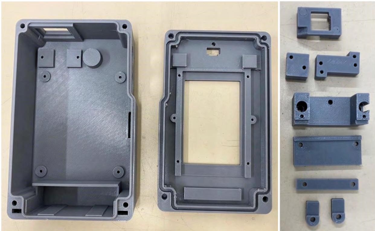
*Pièces imprimées en 3D pour la base du boîtier principal.*
