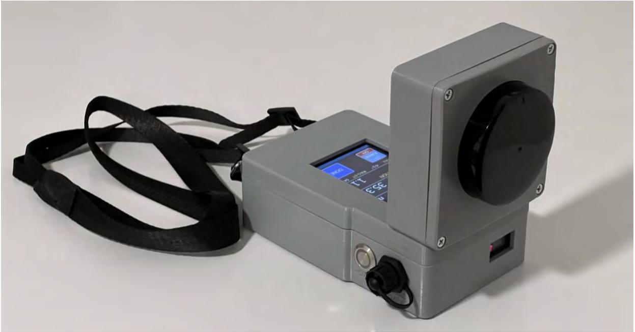
*Caveatron Rev C entièrement assemblé avec le couvercle LIDAR ouvert.*
