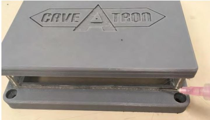
*Ajout de mastic silicone sur les fenêtres LIDAR pour une protection supplémentaire.*
