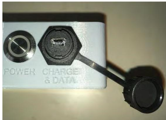
*Position de l'interrupteur d'alimentation, du connecteur USB et du capuchon du connecteur USB vue de l'extérieur.*
