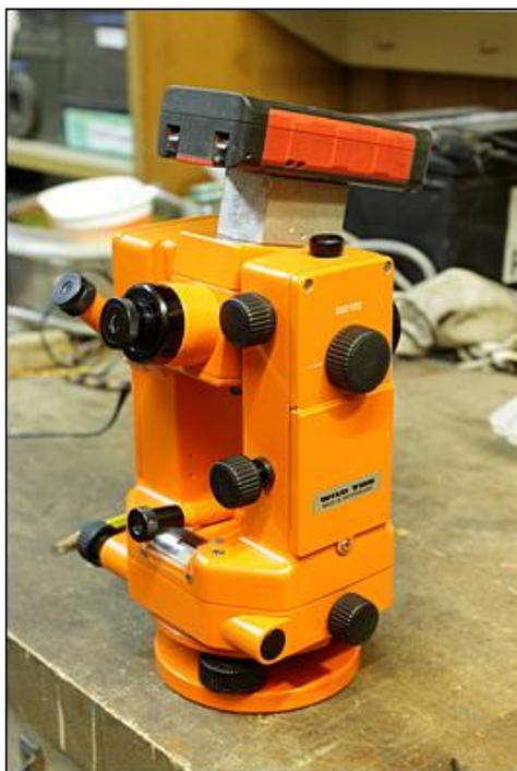
Figure 6 : Le DistoX posé sur le théodolite pour évaluer la pente
