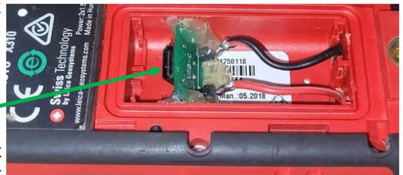
Il faudra aussi limer légèrement l'arrête centrale du couvercle au niveau de la prise USB
