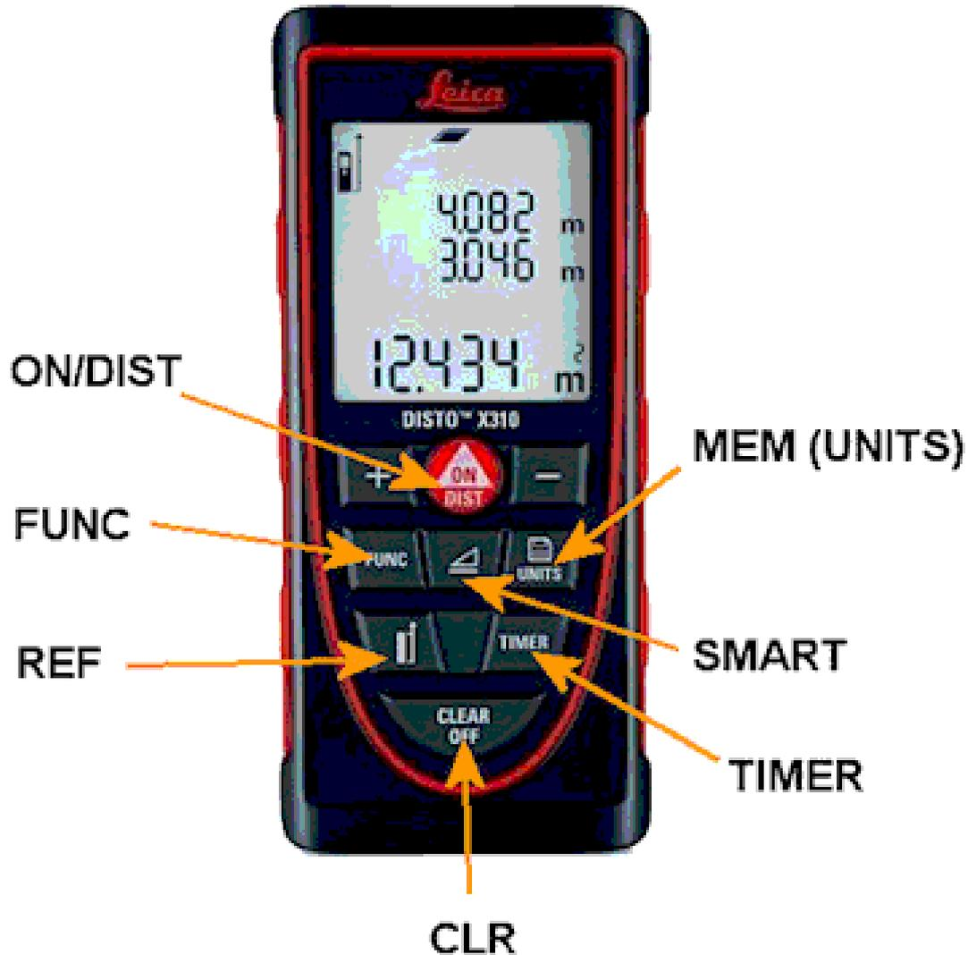
Figure 20 : Les touches de fonction du DistoX310
