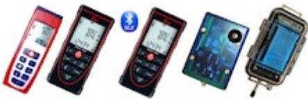
Avant de commencer une topographie, vous devez allumer votre appareil périphérique (à distancemètre laser), le coupler à Android et enfin l'étalonner. Appuyez sur le bouton APPAREIL [dans la fenêtre principale](#) pour ouvrir la fenêtre de ce périphérique. La liste des appareils connus est affichée au milieu. Les appareils pris en charge sont : DistoX, DistoX2, DistoXBLE, SAP5 et BRIC4 (ou 5).
