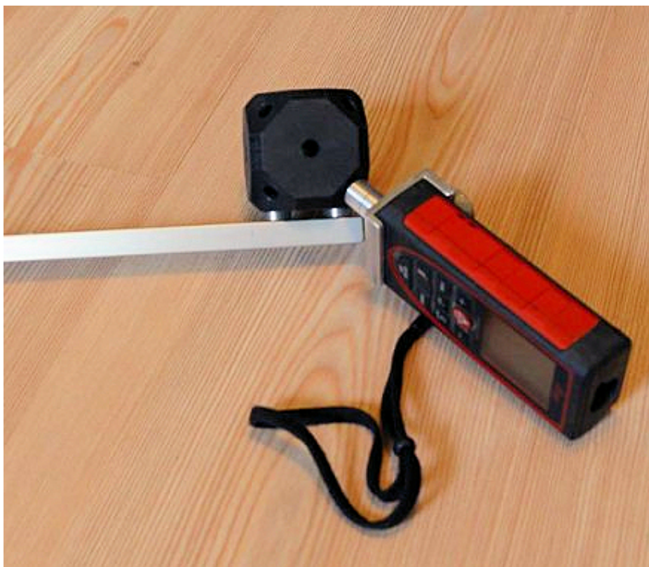
Figure 112 : Le système cube/pivot monté sur la rallonge alu pour pied photo.
