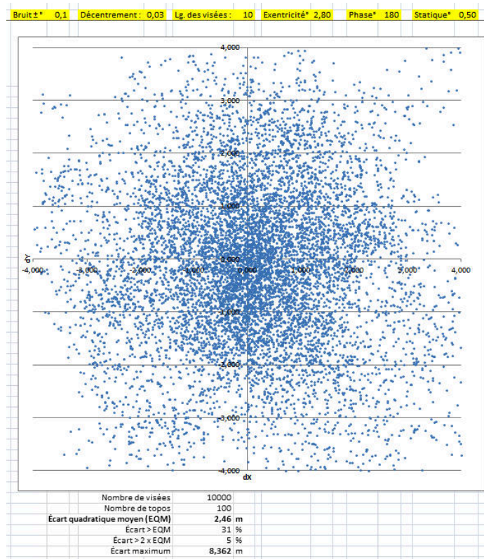
Figure 59 : Précision attendue avec le DistoX n°2 et des visées de 10 m
