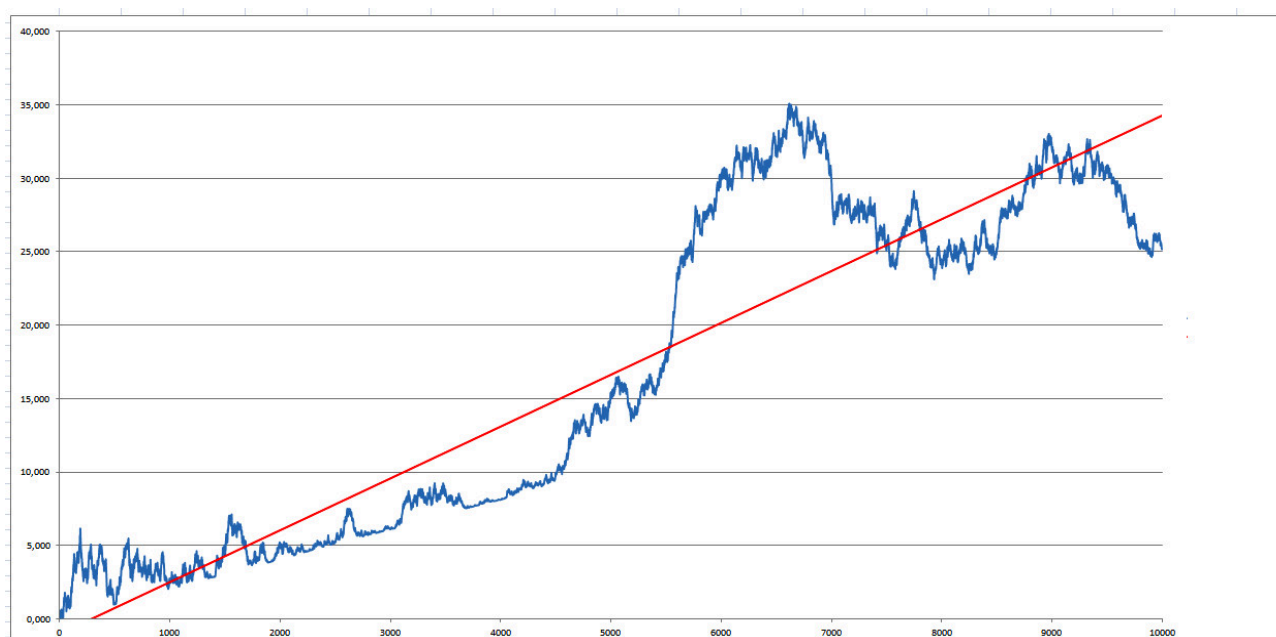
Figure 18 : Propagation de l'erreur de positionnement pour 10 000 visées
