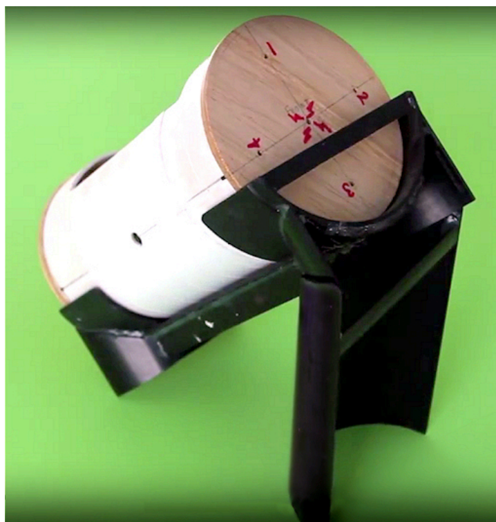
Figure 110 : Un "calibrateur" respectant l'axe du laser en rotation.
