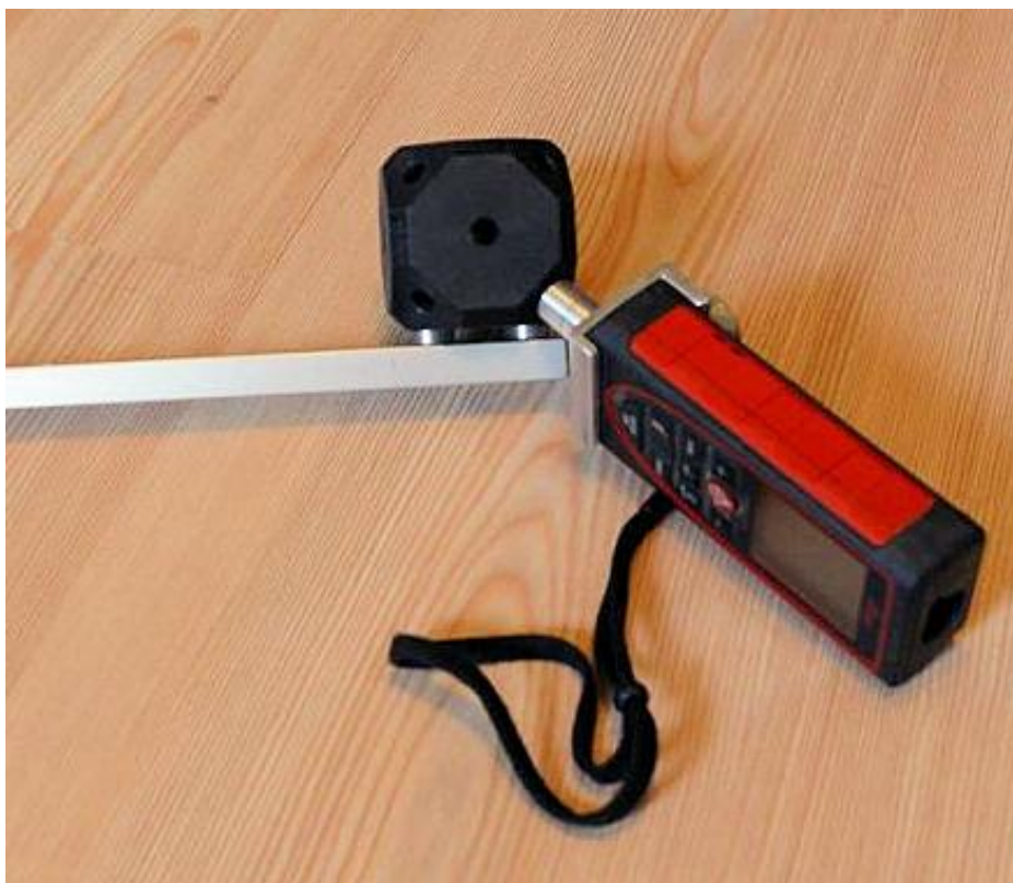
Figure 109 : Le système cube/pivot monté sur la rallonge alu pour pied photo.
