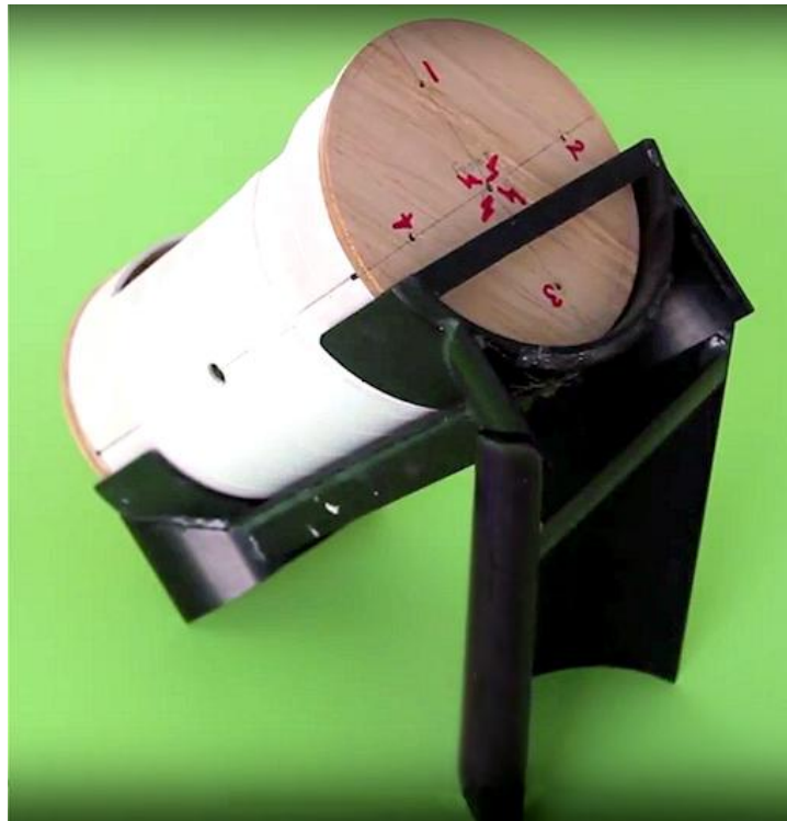
Figure 107 : Un « calibrateur » respectant l'axe du laser en rotation.
