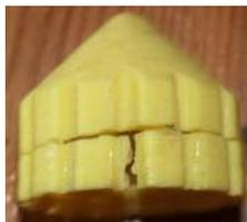
bouchon d'origine (échec réparation par collage) ;
