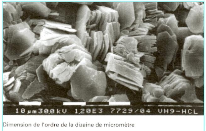
Figure 4 – Cristaux de kaolinite empilés en feuillets, vus au microscope électronique à balayage
