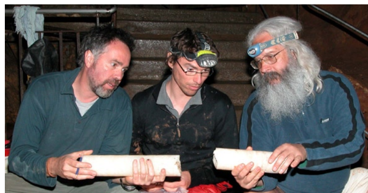
Observation de la carotte au sortir du carottier.*
