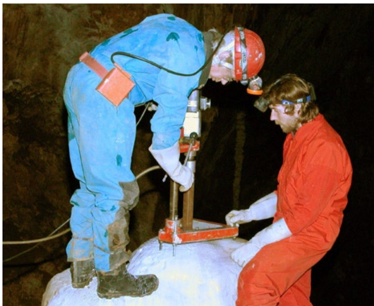
Installation du carottier sur une stalagmite.*
