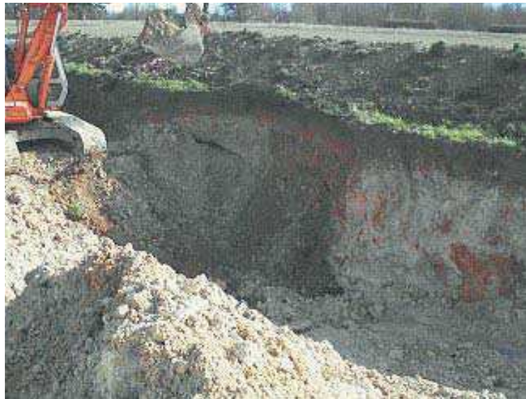
▶▶▶ FIGURE 17 Validation terrain d'une anomalie thermique montrant le bouchon d'un puits de marnière.
