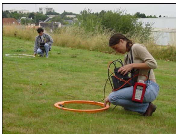
Mesure EM34 : Equidistance 10 m, mode dipôle vertical
