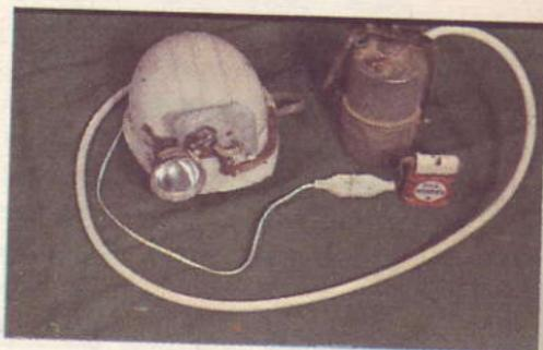
*Équipement mixte avec pile et lampe à carbure.*
