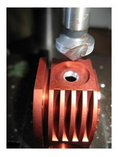
Comme pour le basculeur, mettre le taraud de 8X125 N° 1 dans le mandrin de la perceuse à colonne et tourner à la main deux, trois tours. Finir le taraudage avec un tourne à gauche.
