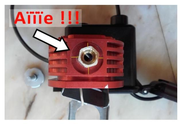
Dans l'illustration ci-dessus l'axe de rotation étant légèrement trop bas, le basculeur force sur les switches et ne revient pas en place seul. La tolérance d'erreur de centrage est inférieure au millimètre! Aidez-vous bien avec le point de centrage pré-percé.
