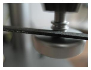
Attention le frottement est normal, nous avons besoin d'étanchéité !!! C'est juste une sensation, un feeling..... il ne doit pas être excessif, c'est tout. Le B/A doit revenir à zéro tout seul avec les ressorts des inters.
