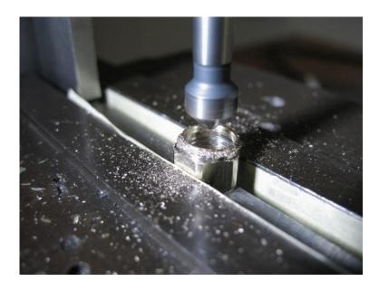
On peut aussi utiliser un foret, mais attention de ne pas engager dans l'écrou !! Prendre un foret de 12 mm et tourner à vitesse lente. Finition et mise à la cote à la lime.
