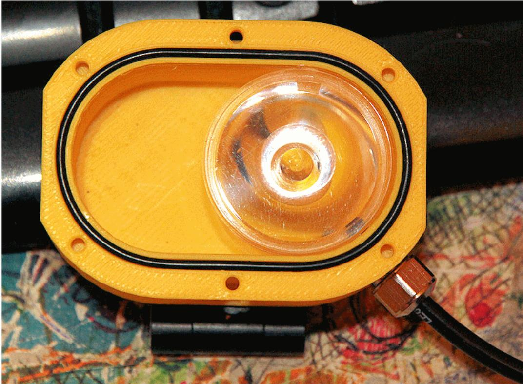
Maquette équipée de ses joint torique, presse-étoupe, câble et lentille spot.
