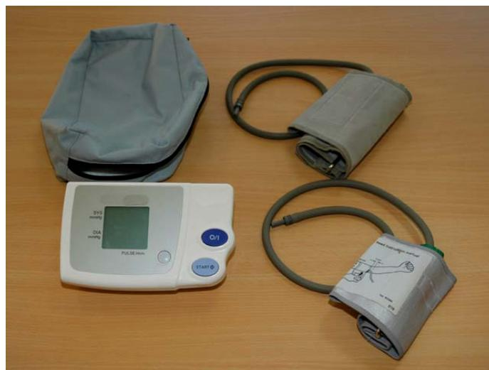
Figure 3.4 : tensiomètre automatique et électronique
