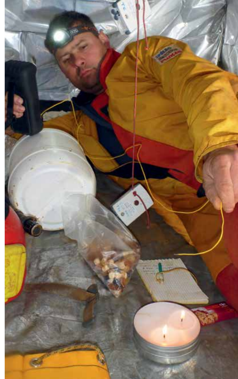
Prise de température par thermomètre à fil. Les sondes de température et d'hygrométrie sont visibles dans le point chaud : elles sont éloignées de la source de chaleur pour éviter toute fausse mesure.
