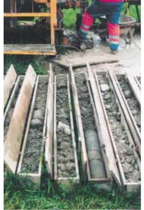
Les carottes de sondage indiquent à quels niveaux le sol est perméable, ou ne l'est pas.
